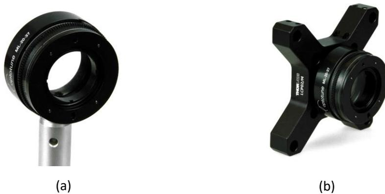
图5a : ML-20-37-VIS-LD-C 安装在标准 1/2" 光学杆支架 (M4 螺丝) 上。图5b : 通过 C 接口转 SM1 适配环 (SM1A39)，安装在 LCP02/M 30-60 mm 光学笼式板适配器上。
